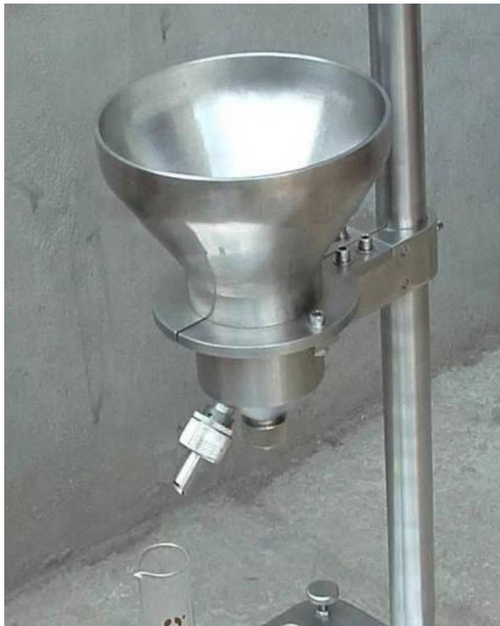
可调整的侧流管，保证测量精度并方便测流管的再次校验
